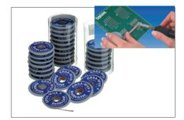
Впитывающая припой медная «косичка» WICK NC с безотмывочным флюсом на антистатической катушке. Используется для очистки контактных площадок от остатков припоя. Длина ленты 1,6 м, варианты ширины — 1,5 мм (для особо плотного монтажа SMT), 2,2 мм (универсальная), 2,7 мм (для очистки площадок под BGA). Цена 2,2 еur.
